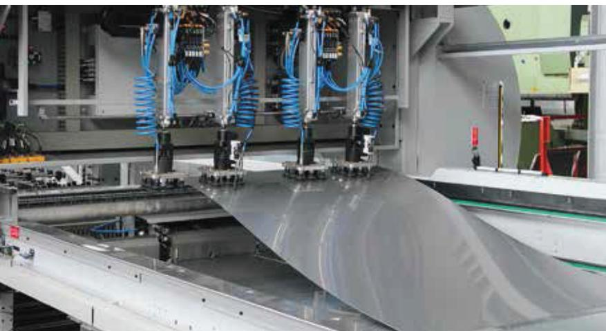
Um sicherzustellen, dass die richtige Platine zugeführt wird, prüft das System beim Beladen die Breite der Platine, die Blechdicke, das Material und die korrekte Position an den Zentrieranschlägen.
